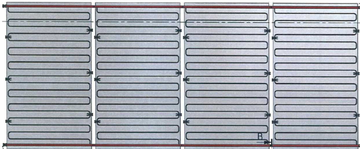
Figure 5 – Schéma hydraulique interne (exemple pour le GK310).
